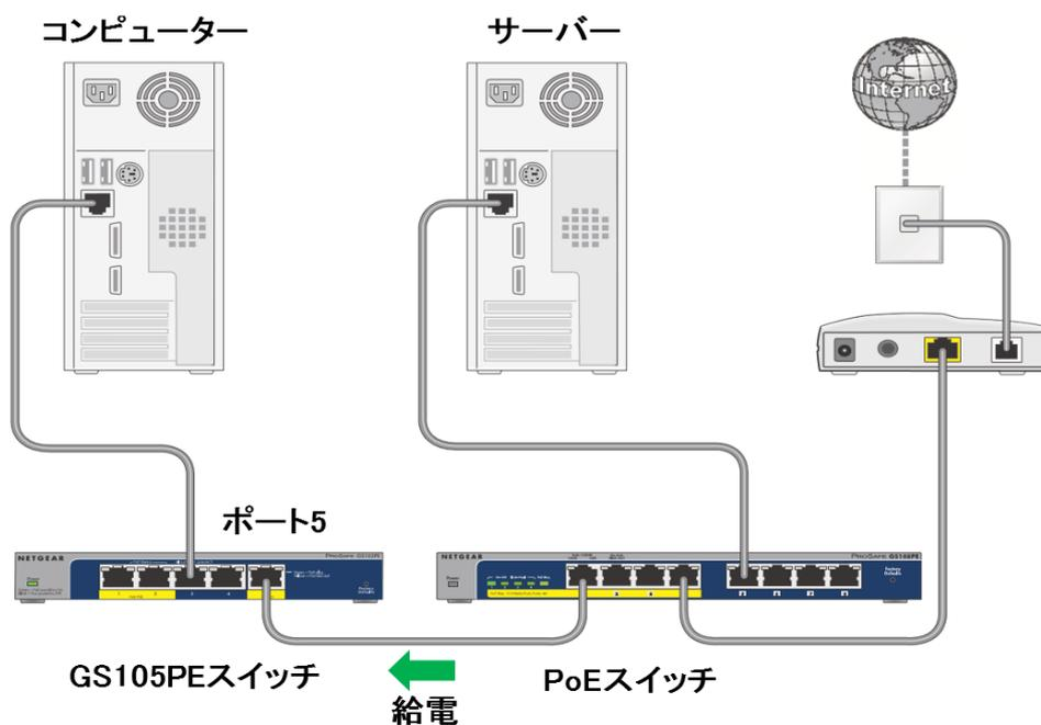
GS105PE のポート 5 を他の PoE スイッチの PoE ポートに接続します。
