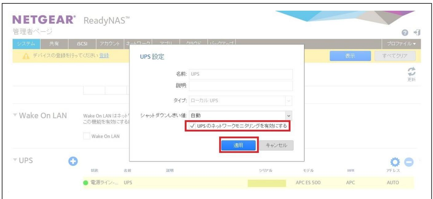
2. [管理画面]>[システム]>[電源]>[UPS]のギアマークより USB UPS を使用している ReadyNAS の IP と接続情報を入力し、[追加]します。
