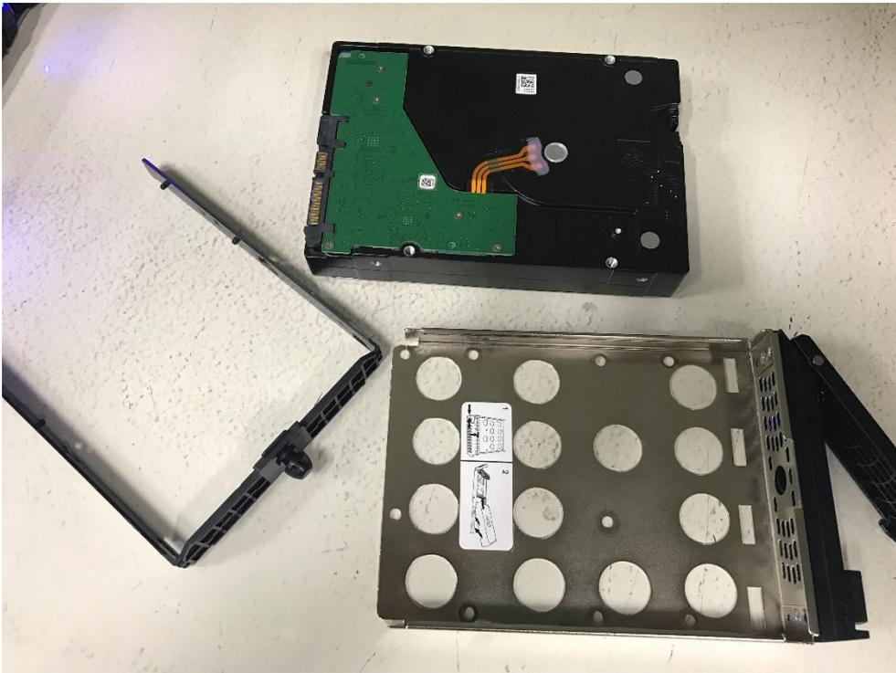
5. 背面のネジ穴に合う様にディスクを配置します。
