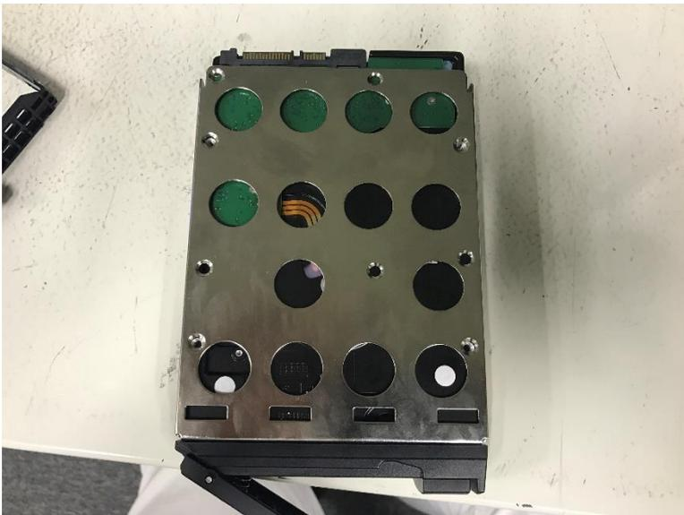
6. 付属のディスク用のネジを使用し、ネジ穴が合う箇所をネジ止めします。
