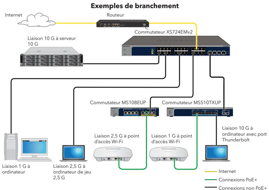
**REMARQUE :** Nous vous recommandons d'utiliser des câbles Ethernet de catégorie 5e (Cat 5e) ou supérieure munis de connecteurs RJ-45. Pour utiliser un port SFP+, vous devez insérer un module émetteur-récepteur SFP+ 10 G ou SFP 1 G, disponible auprès de NETGEAR.
