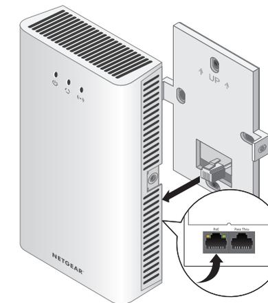
7. (Opzionale) Collegare il cavo Ethernet fornendo il supporto pass-through alla porta corrispondente sul retro dell'access point.
