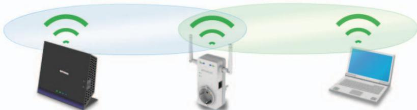
Sollte es nicht möglich sein, den Repeater in der Mitte zu positionieren, stellen Sie den Repeater näher an den Standort mit schlechter Abdeckung heran, aber weiterhin in Reichweite des Routers.
