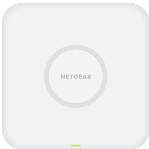
Illustration 1 : Panneau supérieur avec LED
