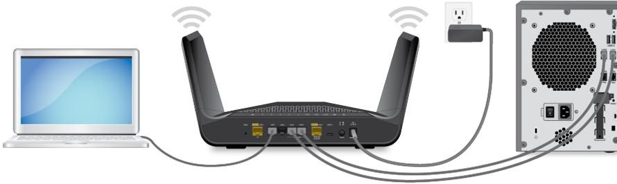
Abbildung 8: Aggregation des Ethernet-Ports zu einem LAN-Gerät
