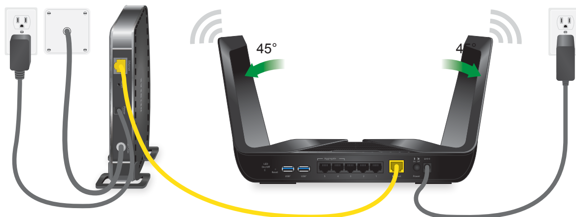
図6: ケーブルの接続
