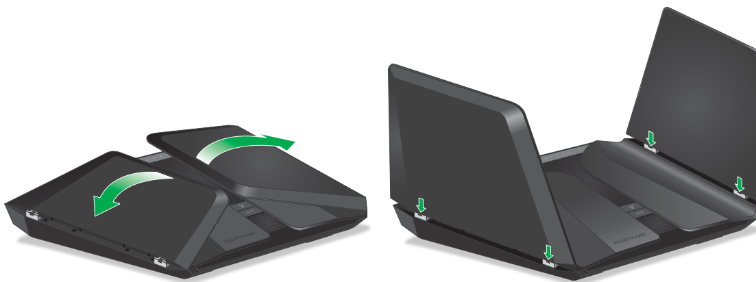
図4: アンテナを設置する
