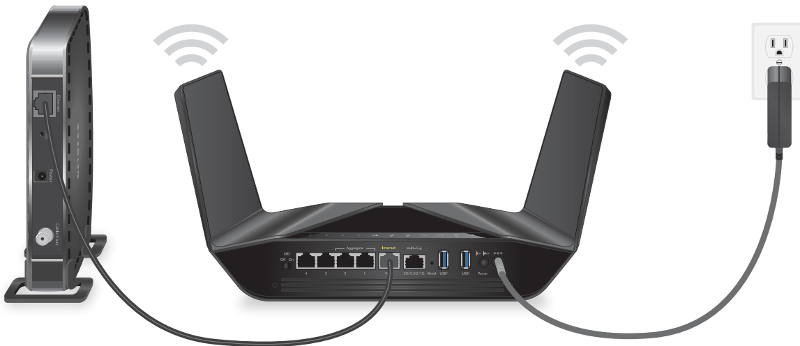
図6: ケーブルの接続
