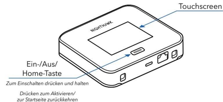
Halten Sie die **Ein-/Aus-/Home-Taste** zwei Sekunden lang gedrückt, um den Router einzuschalten. Folgen Sie dann den Anweisungen auf dem Bildschirm, um die Einrichtung abzuschließen.
