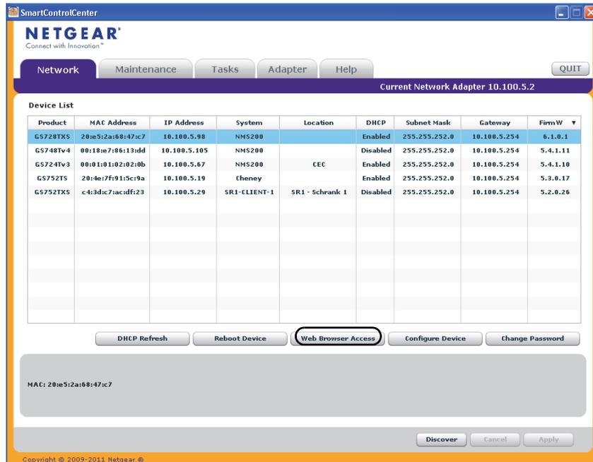
Si l'utilitaire ne détecte pas votre commutateur, vérifiez que les connexions des câbles ont été correctement effectuées et que l'adresse IP de l'ordinateur appartient au même sous-réseau que le commutateur, puis cliquez sur le bouton **Discover** (Détecter).
