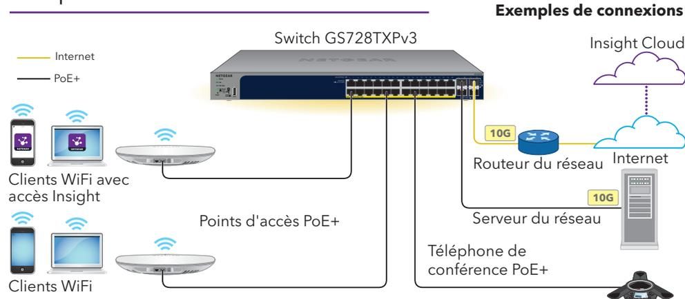
1. Connectez les appareils aux ports réseau RJ-45 (selon le modèle, 1-24 ou 1-48) sur le panneau avant du switch.
