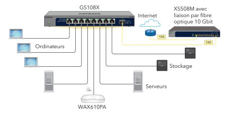
REMARQUE: Nous vous recommandons d'utiliser un câble de catégorie 6a (Cat 6a) ou un câble de catégorie supérieure pour les connexions Ethernet 10 Gbit, ainsi qu'un câble de catégorie 5e (Cat 5e) ou un câble de catégorie supérieure pour les autres connexions Gigabit Ethernet.
