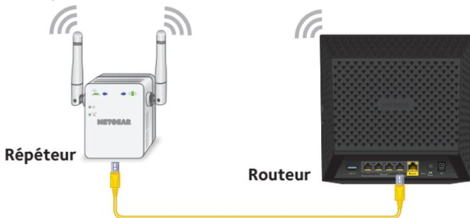
1. Utilisez un câble Ethernet pour relier le port Ethernet du répéteur au port de réseau local Ethernet sur un routeur ou une prise LAN Ethernet distante avec accès au réseau local.
