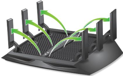
Richten Sie die Antennen aus, um eine optimale WLAN-Leistung zu erzielen.
